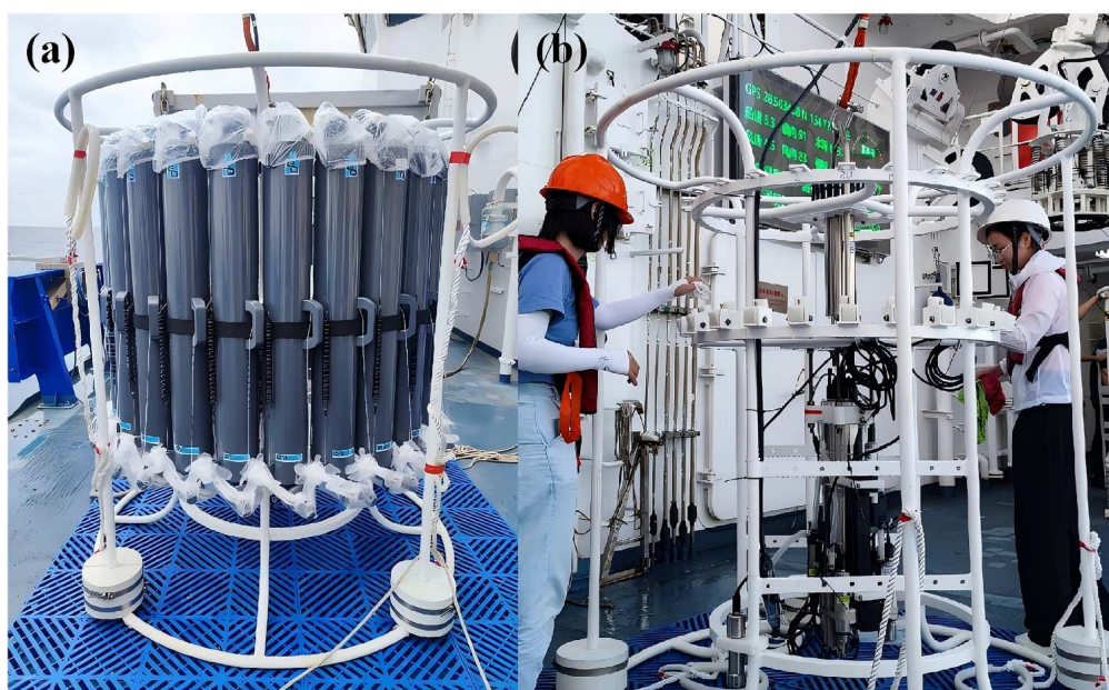
图1 厦门大学痕量金属洁净采样系统。(a) Niskin-X采水瓶;(b) 葵花采水架
