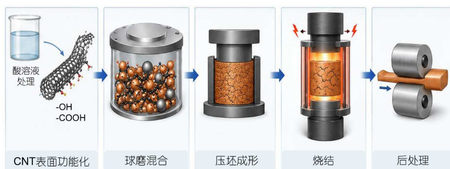
图2 粉末冶金法制备CNT/Cu复合导体典型流程图
