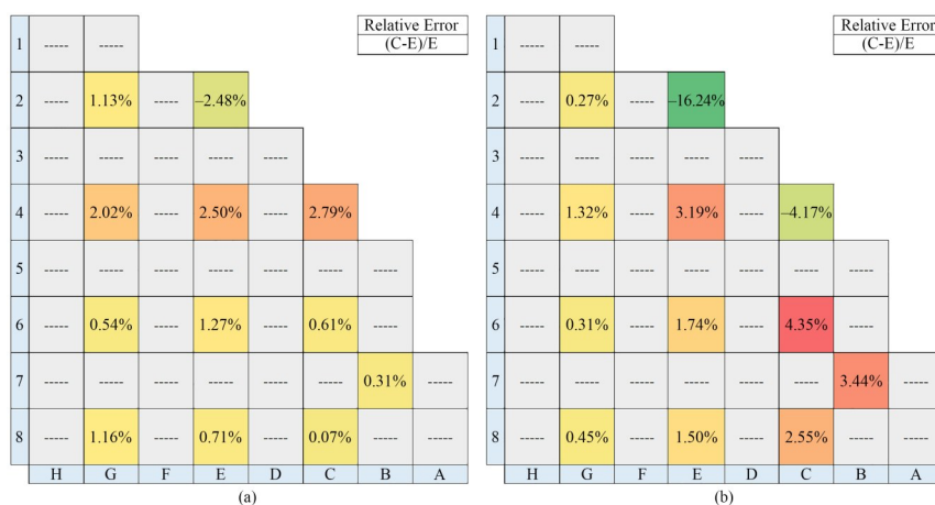
图4 AP1000堆芯SPND响应电流计算误差( Bu=11\,271.7\text{ MWd}\cdot\text{tU}^{-1} ) (彩图见网络版)
