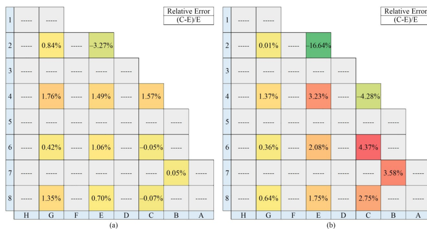
图5 AP1000堆芯SPND响应电流计算误差( Bu=12\,642.5\text{ MWd}\cdot\text{tU}^{-1} ) (彩图见网络版)
