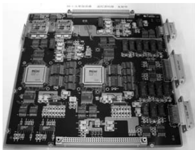
图 5 遥控译码器飞行件
