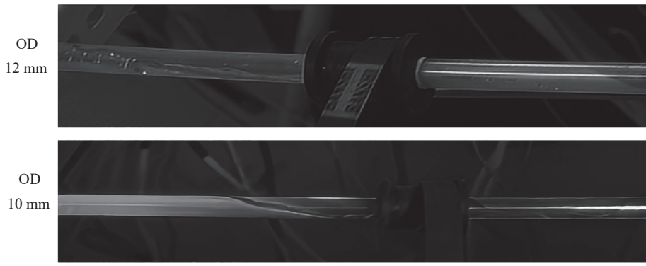
图 4 50\text{ mL}\cdot\text{min}^{-1} 时的螺旋状流
