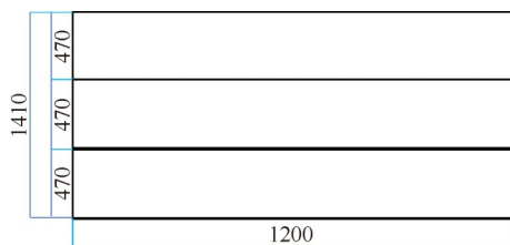
图4 三跨直立锁缝屋面几何尺寸 mm
