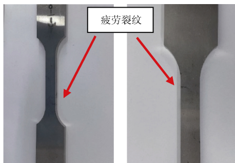
图 7 试件疲劳裂纹位置
