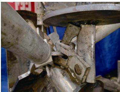
图 19 斜杆抗压试验破坏形式
