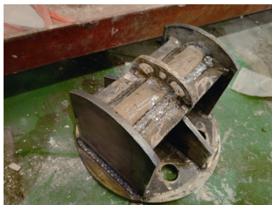
图 13 横杆抗压试验破坏形式
