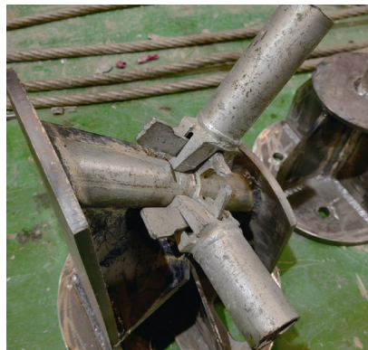
图 16 斜杆抗拉试验破坏形式
