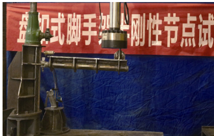
图 6 横杆抗弯试验照片
