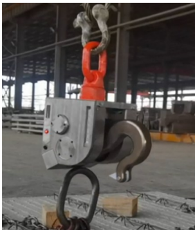
(a) 智能吊钩完全打开状态
