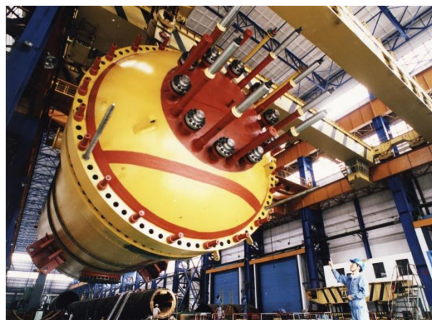
图4 10 MW 高温气冷实验堆压力壳 [1]142 （1998年11月，王呈选摄）
