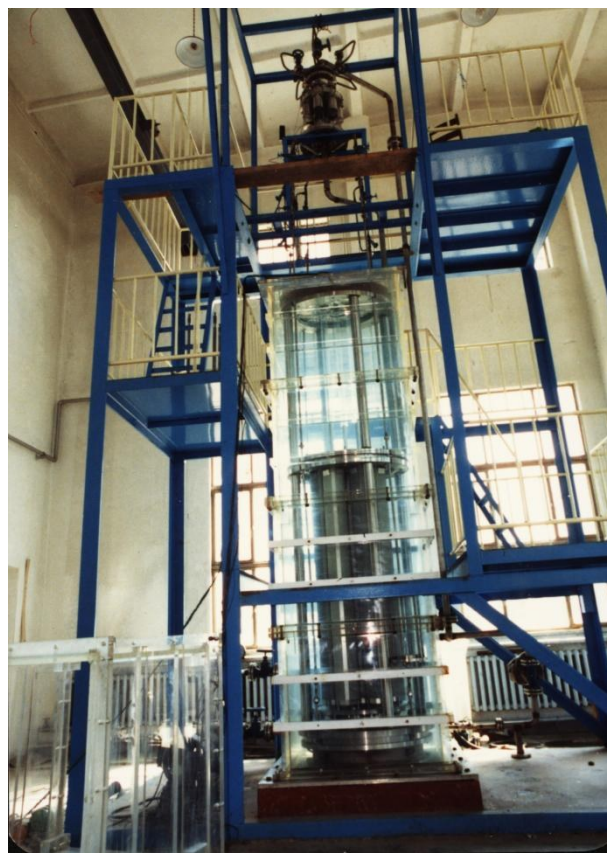
图 3 5 MW 低温核供热试验堆水力驱动控制棒实验台架 [1][24] (1989 年, 王呈选摄)
