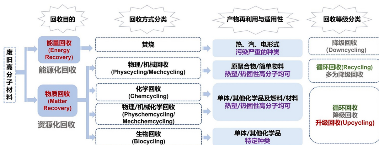
图 2 (网络版彩图)废弃高分子材料的回收方法(本图根据回收目的,将现有回收方法分为能量回收与物质回收两大类;物质回收进一步细分为物理/机械回收、化学回收及生物回收等路径,并标注了各类回收方式典型的产物形式、适用的材料及在循环经济中的回收等级)
