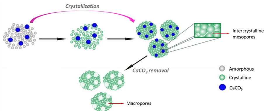
图1 (网络版彩图)硬模板法制备多级孔分子筛示意图 [37]
