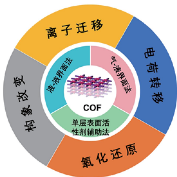
图1 COF薄膜的制备及在忆阻器中的应用(网络版彩图)
