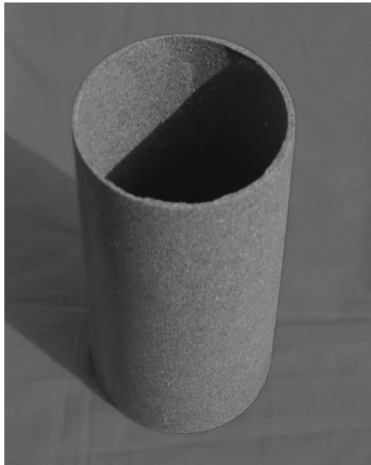
图 6 采用沙子做成的防护管件
