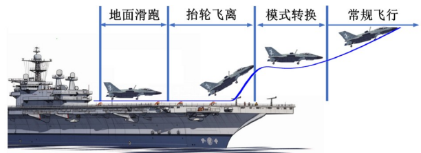
图4 (网络版彩图)垂直/短距起降飞机短距起飞到常规飞行过程分解
