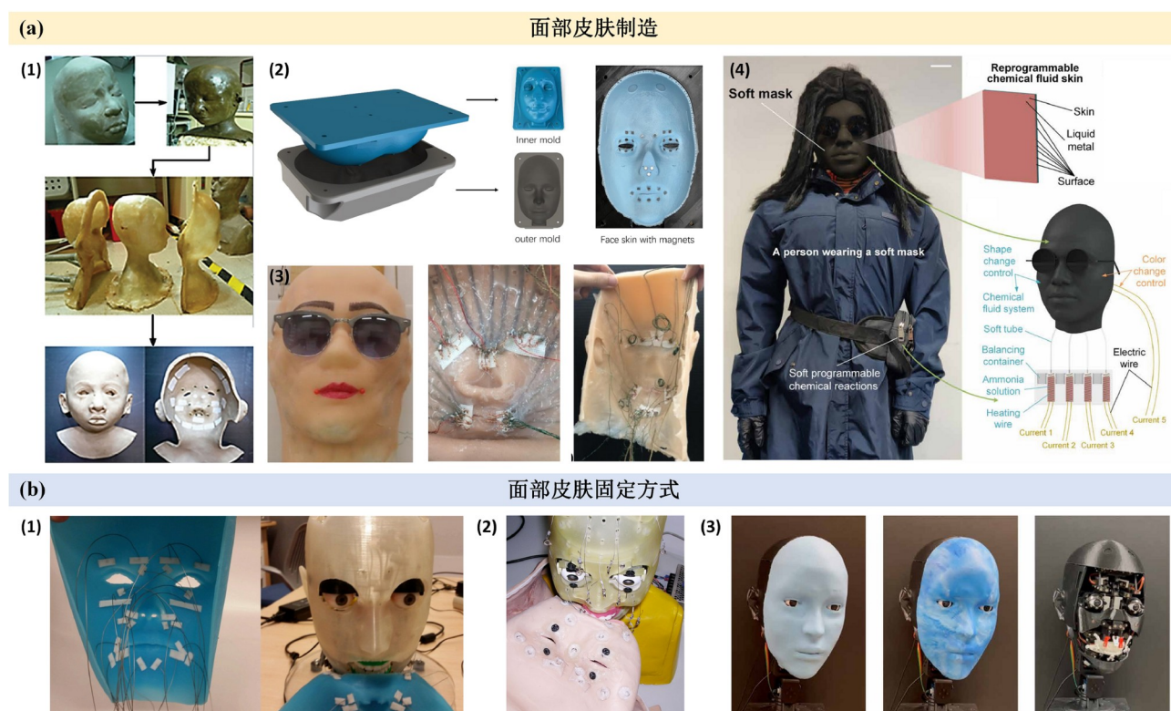
图 4 (网络版彩图)面部机器人皮肤的制造技术。(a) 机器人面部皮肤制造。(1) 包覆成型: 通过成型、注射和固化聚氨酯橡胶来制造面部皮肤 [54] 。(2) 3D打印辅助成型: 使用3D打印机打印内外模具, 然后将两个模具组合以获得机器人面部皮肤 [43] 。(3) 嵌入式制造: 将TCP人工肌肉嵌入硅胶橡胶皮肤 [46] 。(4) 嵌入式制造: 将化学流体结合到面部皮肤中 [56] 。(b) 皮肤粘合剂黏合法 [25] 。(2) 卡扣连接法 [58] 。(3) 磁铁法 [43]
