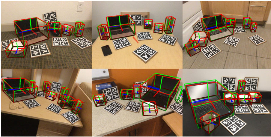
图 2 (网络版彩图)REAL275数据集6个真实场景中预测姿态的定性结果, 绿色边框为真实值, 红色边框为预测值
