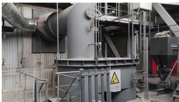
图 18 (网络版彩图) 24 MW th 预热器预热燃料旋流喷嘴
