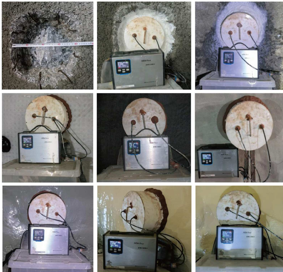
图 1 防水抑氡层各工艺面氡析出率测量现场
