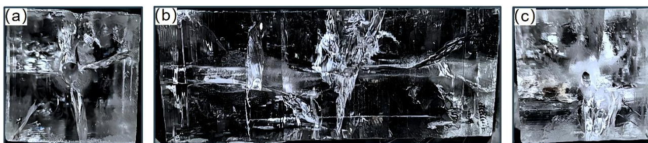
图 4 激光击穿后冰样效果。(a) 激光入射口状态;(b) 正面裂纹状态;(c) 激光出射口状态
