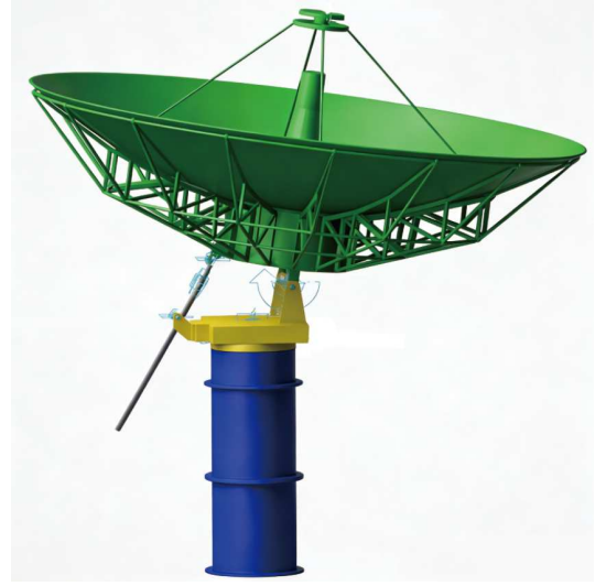
图 11 7.3 m 天线动力学模型 Figure 11 7.3 m antenna dynamic model.
