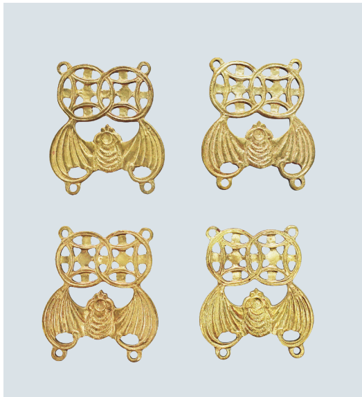
图13 3D打印后铸造黄铜配件
